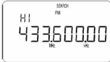
Maintenant la banque numéro 5 est programmée pour rechercher les fréquences comprises entre 433 et 433,6 MHz en FM avec un PAS d'incrémantation de 25 KHz (sans atténuateur).
