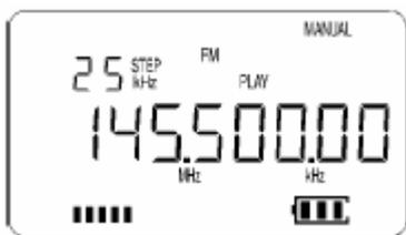
► L'appui sur les touches **[2nd.F]** puis **[4]** ( **[REC/PLAY]** ) durant plus d'une seconde, lance l'enregistrement. "**REC**" est alors affiché. Le barre-graphe indique la progression jusqu'aux environs de 20 secondes.
