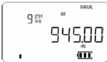
Si l'affichage affiche une fréquence légèrement différente, c'est peut être dû au fait que des modes et des PAS d'incrémentations ont été pré-programmés (*voir chapitres 8 et 9*) dans le scanner.
