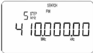
"**STEP**" clignote. A l'aide du bouton **[DIAL]** ou des touches **[√•]** ou **[v]** sélectionner le PAS d'incrémentation (STEP).
