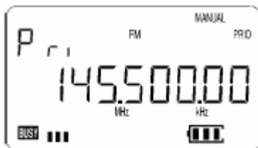
L'appui sur les touches **[2nd.F]** puis **[PRIO]** ( **[PRIO/SET]** ) durant plus d'une seconde, permet de choisir l'intervalle de temps entre 2 veilles de cette fréquence. Utiliser le bouton **[DIAL]** ou les touches **[↖]** ou **[↘]** pour sélectionner la période entre 1 et 19 secondes et appuyer sur **[ENT]** pour valider.
