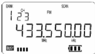
Si **[SCAN]** est pressée une seconde fois, la fréquence affichée est alors transférée dans le VFO en mode manuel.
