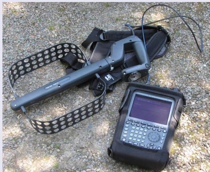
R&S®PR100 Portable Receiver et antenne HE 100 / HE 300
